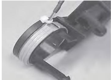
E. À l'aide d'une des attaches autoblocantes fournies, fixez la bobine de l'antenne comme illustré.
