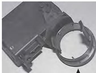
Bobine de l'antenne de l'émetteur-récepteur
