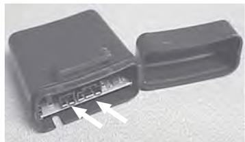
G. Acheminez le connecteur à deux broches de la boucle de l'antenne et branchez-le sur l'interface SKIM/SKREEM. Branchez le connecteur à quatre broches du faisceau du démarreur à distance et branchez-le sur l'interface SKIM/SKREEM.
