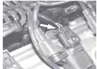
J. Acheminez le fil vert foncé jusqu'à la boîte de raccordement du relais du côté passager du compartiment moteur. Retirez le relais du klaxon comme le montre le schéma. Glissez le connecteur fourni de la borne du relais sur la borne 85 du relais, comme le montre le schéma. Remettez le relais en place. Acheminez le câblage provenant du connecteur du relais hors de la boîte de raccordement et reliez-le au fil vert foncé à l'aide du connecteur bout-à-bout fourni.
