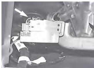
F. Localisez le fil blanc/marron de la broche n° 1 du connecteur à 10 broches, au niveau du commutateur des phares. Connectez par épissure centrale le fil blanc/marron du faisceau à ce fil, en suivant la procédure d'épissure centrale de la page 24.
