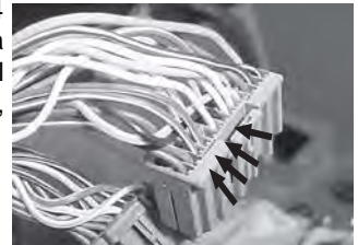
Conexiones apertura automática de puertas Clavijas 1 a 4, conector gris
